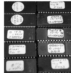
Der verlorene Schatz: Vom Programmierer beschriftete EPROMs aus dem Hause Atari.
